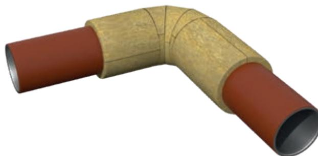
Схема изоляции отводов и тройников малых диаметров
